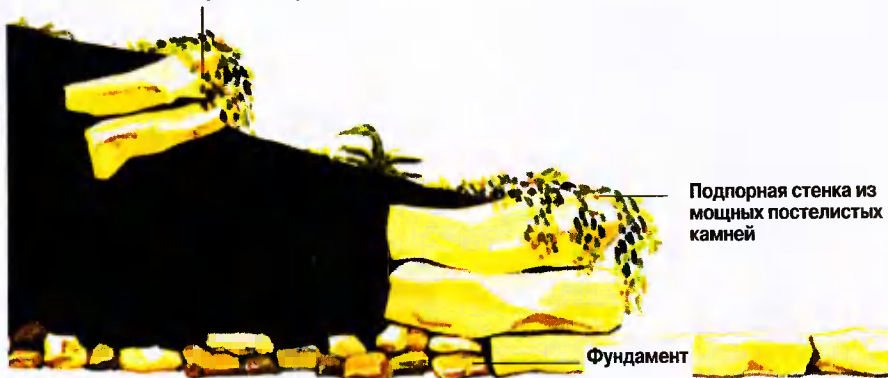
Рис. 4. Подпорные стенки возводят так же, как и свободно стоящие «сухие» стены. Обычно их сооружают для придания пологим склонам декоративной рамки
